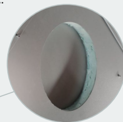
Dwustronna ściana piankowa blokująca laser
